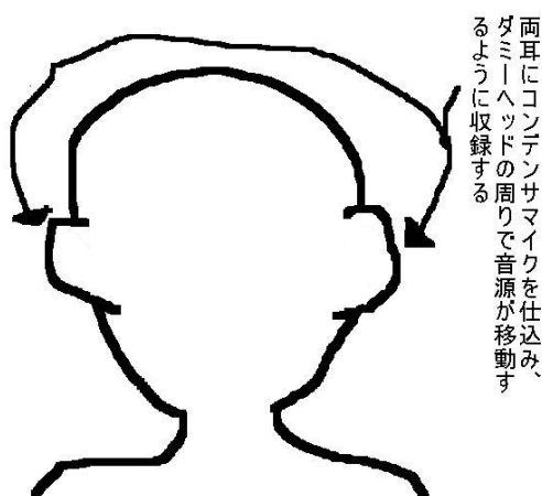
図 1 バイノーラル方式での収録方法
